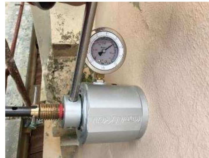
Test di estrazione in situ
